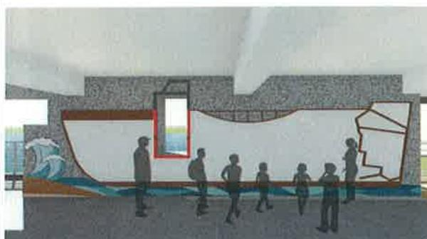
說明：將舊有佈告欄拆除以及原有牆面馬賽克磚已有部分磁磚剝落整修改善，牆面新增磁性白板，可做為教學白板，並以嘉義布袋漁港發想，將磁性白板設計成船身造型。
